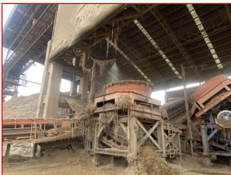
ภาพที่ 2.2-48 หัวพ่นน้ำ (Spray Nozzle) ที่เครื่องย่อยใบอ้อย
